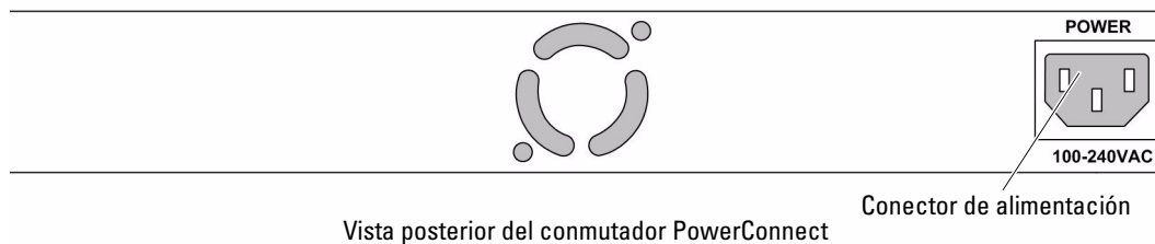
Figura 1-4. Conectores de alimentación del panel posterior
